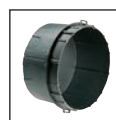
CS 1085 per installazione a parete Controcassa in tecnopolimero da incassare nel muro prima dell'installazione della lampada Ø 185 mm - h. 130 mm. Non può essere installata a pavimento. CS 1085 for wall fixing only Technopolymer holder to be fitted into the wall before the installation of the luminaire Ø 185 mm - h. 130 mm. Not to be fitted as a buried uplighter.
