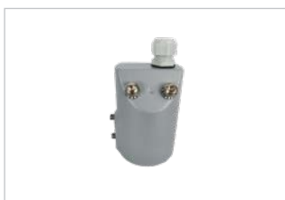
AKRON 1 60235 NEXT 2 - 3 - 4 - 6 - 8 Pour montage d'un appareil individuel sur tête de mât Ø 60 mm, constitué d'un bloc en alliage d'aluminium moulé sous pression, peint couleur Argent. Para montaje de un proyector único de cabeza palo Ø mm 60, compuesto por un bloque de aleación de aluminio fundido a presión, barnizado de color Silver.
